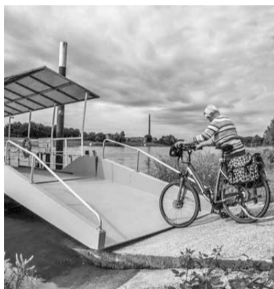
Boven afbeelding van prototype nieuwe voetveer met fluïstermotor en een dak van zonnepanelen. Onder afbeelding van de laadklep aan de voorzijde die morgenochtend getest gaat worden.
